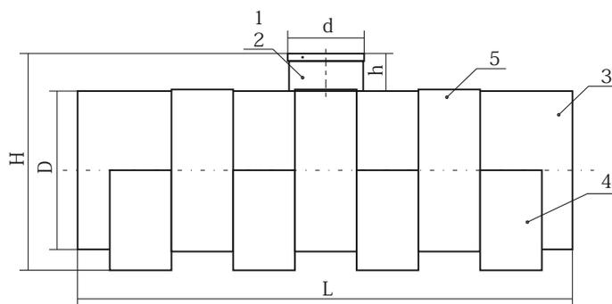
1 - крышка емкости, 2 - горловина, 3 - корпус емкости, 4 - ножки, 5 - ребра жесткости,  $D$  - диаметр емкости,  $L$  - длина емкости,  $H$  - общая высота,  $d$  - диаметр горловины,  $h$  - высота горловины.
