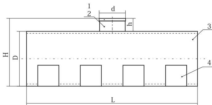
1 - крышка емкости, 2 - горловина, 3 - корпус емкости, 4 - ножки,  $D$  - диаметр емкости,  $L$  - длина емкости,  $H$  - общая высота,  $d$  - диаметр горловины,  $h$  - высота горловины.
