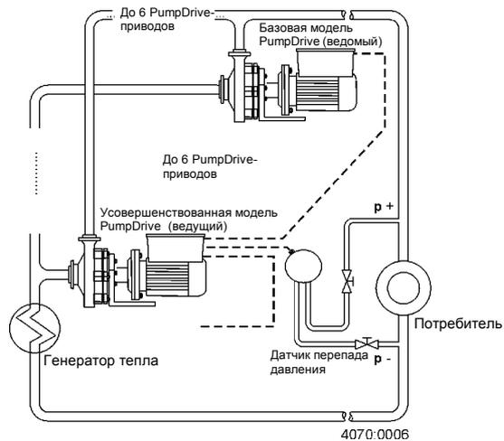
В режиме ведущий-ведомый возможна параллельная работа до шести PumpDrive-приводов.
