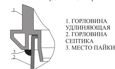
Рис 3. Монтаж удлиняющей горловины
