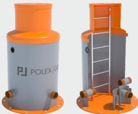
Согласно Рекомендациям по расчёту систем сбора, отведения и очистки поверхностного стока ФГУП «НИИ ВОДГЕО» необходимо очищать первые, наиболее загрязненные порции сточных вод. При отсутствии требований к очистке 100% годового стока рекомендуется использовать распределительный колодец POLEX-ST-RK, который обеспечивает подачу расчетного значения загрязнённого стока в систему очистки, а условно чистый сток направляется по обводной линии.
