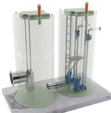
Данный вариант КНС используется в тех случаях, когда есть необходимость в увеличении объема приемного резервуара. В таких случаях может устанавливаться одна или несколько дополнительных приемных камер.
