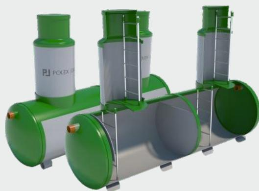
В пескоотделителе POLEX-ST-OP из сточных вод выделяются твердые частицы. Принцип действия пескоотделителя основан на законе гравитации - взвешенные вещества оседают на дно емкости. Твердые вещества и иловый осадок удаляются.
