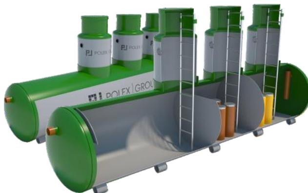
Для очистки ливневых стоков при небольших нагрузках, до 50 л/с, рекомендуется использовать комплексную систему очистки POLEX-OP-BMO-SB. Она выполнена в едином корпусе из армированного стеклопластика и включает в себя: пескоотделитель, маслобензоотделитель и сорбционный блок.
