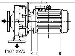
Положение отверстий для конденсированной воды
