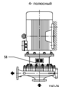
При вертикальной установке предусмотрен клапан выпуска воздуха для предотвращения сухого хода торцевого уплотнения
