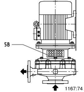
При вертикальной установке предусмотрен клапан выпуска воздуха для предотвращения сухого хода торцевого уплотнения.
