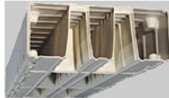
Понтон имеет ячеистую структуру, которая при небольшом снижении плавучести придает изделию высокую прочность, а так же позволяет отказаться от заполнения пеной, что снижает вес и стоимость изделия.
